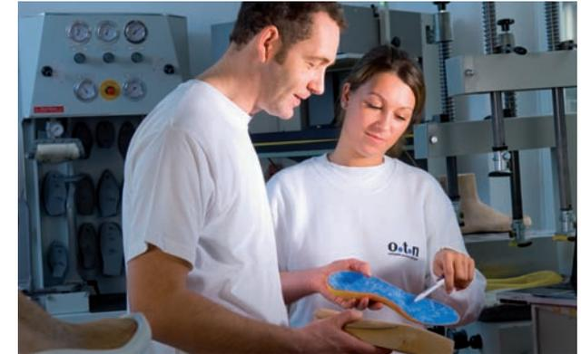
Fertigung der individuellen Einlagen über einen speziellen Leisten.
